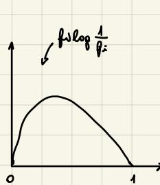
$$H = \sum_{i=1}^k f_i \log \frac{1}{f_i} = - \sum_{i=1}^k f_i \log f_i \text{ è detta indice di entropia del campione}$$
